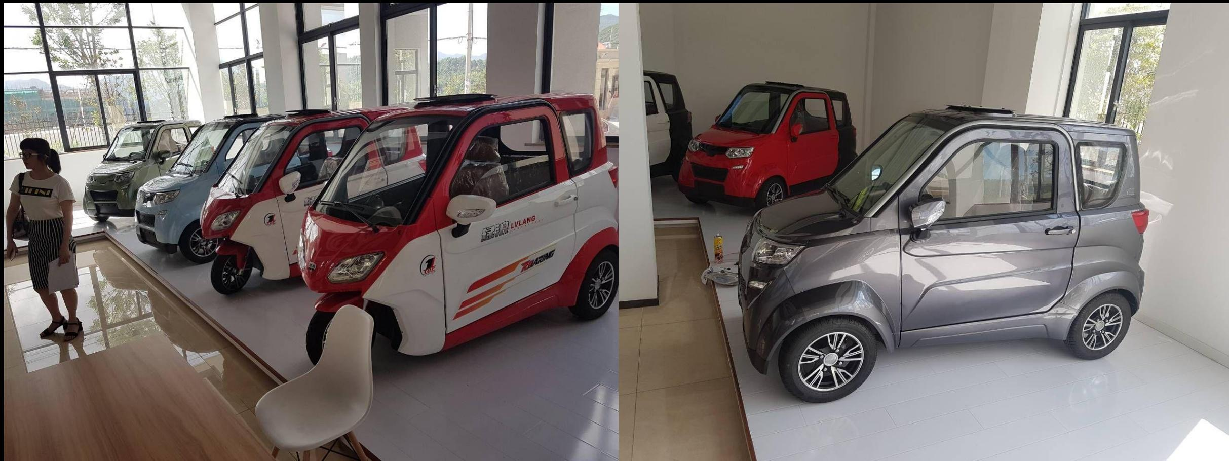
**Два типа кузова на одном шасси.
