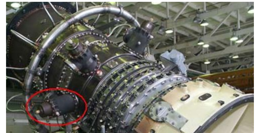
ГТУ 12ПГ-2 на базе двигателя ПС-90А
