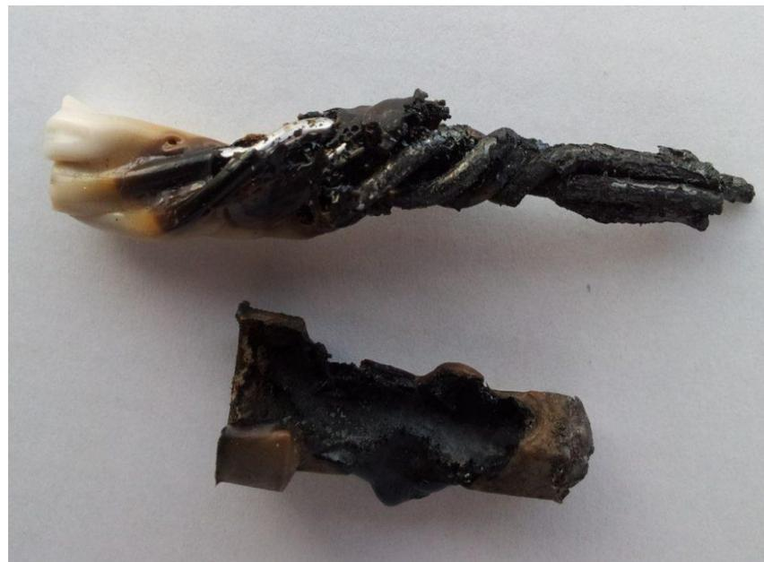
происходит из-за слабого крепления и сильного окисления контактных поверхностей и мест соединения проводов.
