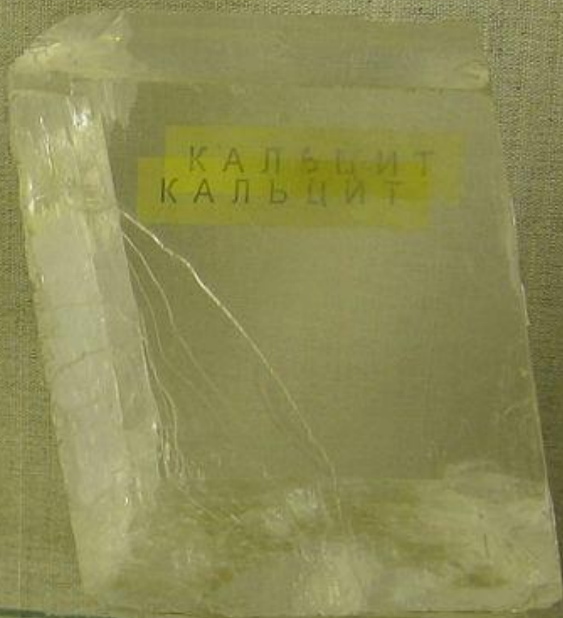
КАЛЬЦИТ CaCO 3 8476 блеск стеклянный, n = 1.49-1.66 оптически анизотропный минерал Исландия
