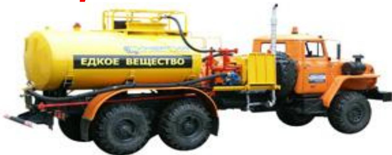
Насосный агрегат с защитным покрытием
