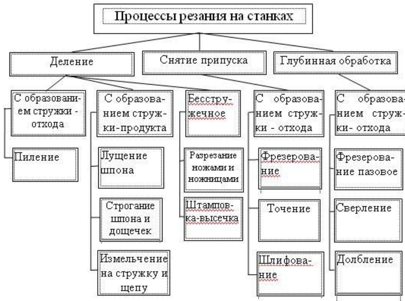
Рис. 51. Классификация процессов станочного резания
