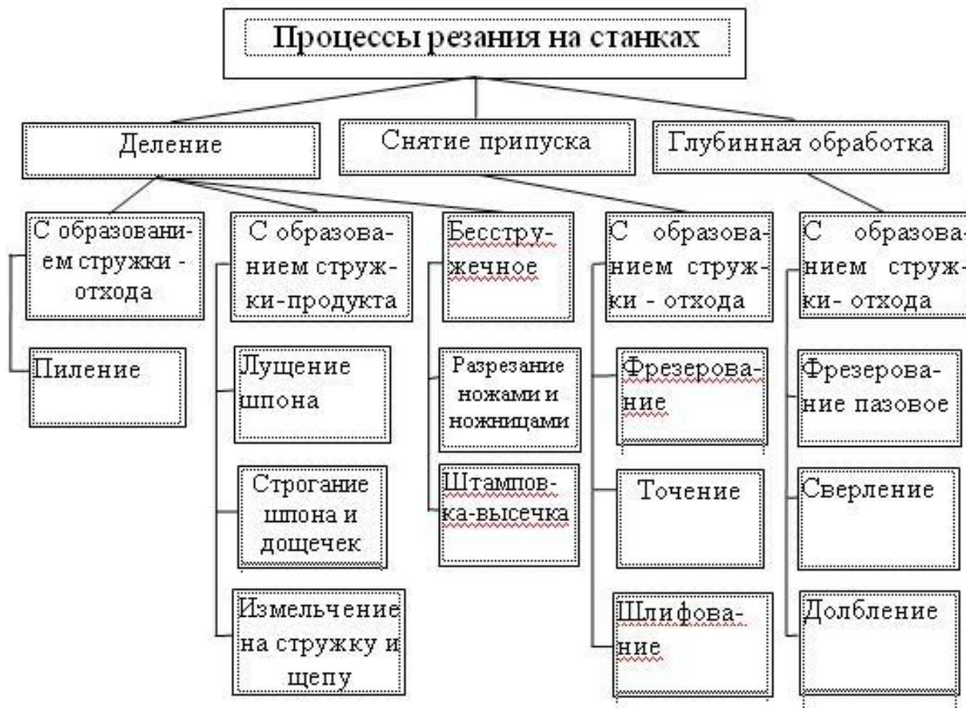
Рис. 51. Классификация процессов станочного резания
