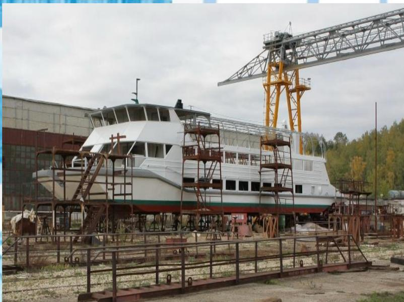
В 2010 году ООО «Городецкий СРЗ» для туристической компании «ГАМА» выполнил заказ по строительству мелкосидящего туристического дизель-электро-хода «Сура» нового поколения с колесным двигателем. "Сура" - колесный теплоход с гидравлическим приводом гребных колес, длиной 34 м, шириной 10,8 м, водоизмещением 80 т. Рассчитан на 40 пассажиров и 11 членов экипажа. Может развивать скорость до 16 км/ч., осадка корпуса всего лишь 60 сантиметров. В 2012 заложено 2-е судно
