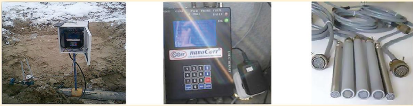
Системы онлайн мониторинга коррозии «Монитор II Nano Corr»
