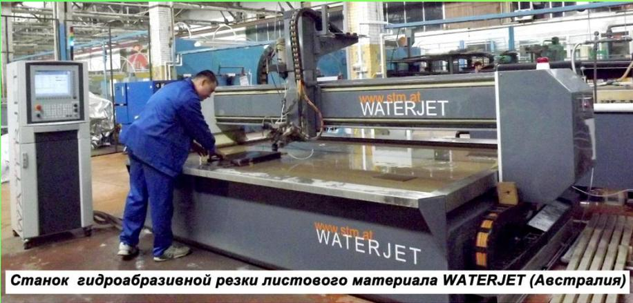
Станок гидроабразивной резки листового материала WATERJET (Австралия)
