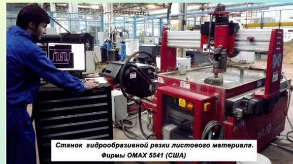
Станок гидроабразивной резки листового материала. Фирмы OMAX 5541 (США)
