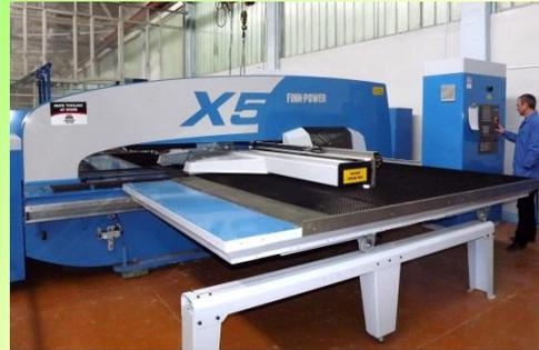
Координатно-пробивной револьверный пресс с ЧПУ фирмы FINN POWER
