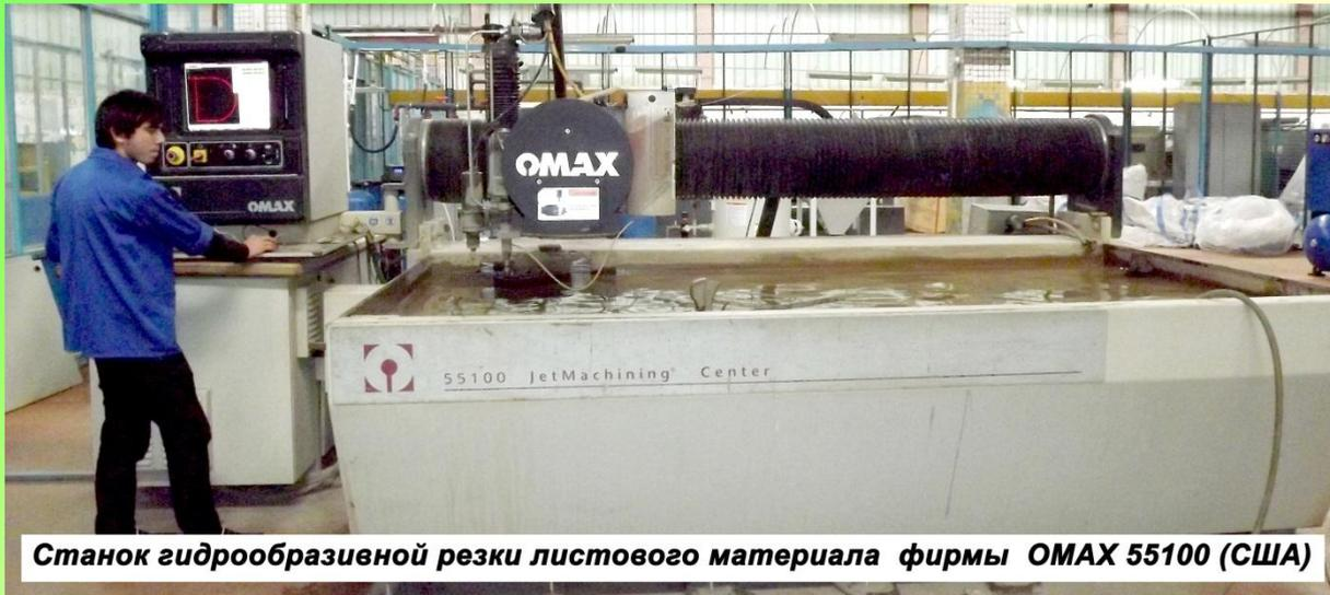
Станок гидроабразивной резки листового материала фирмы OMAX 55100 (США)
