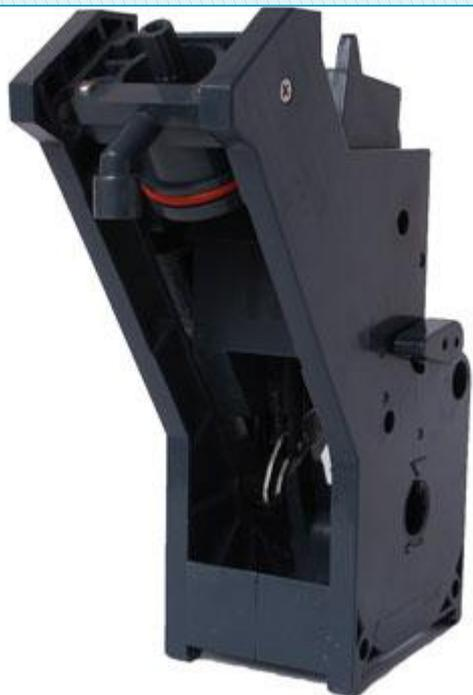
**Дозирующие устройства** в автоматах служат для отделения заданной по величине дозы или порции от общей массы товара. Работа дозаторов основана на различных принципах дозирования: по объему, массе, времени. В автоматах для продажи штучных товаров дозирующими устройствами являются заслонки - отсекатели, ограничители и др.
