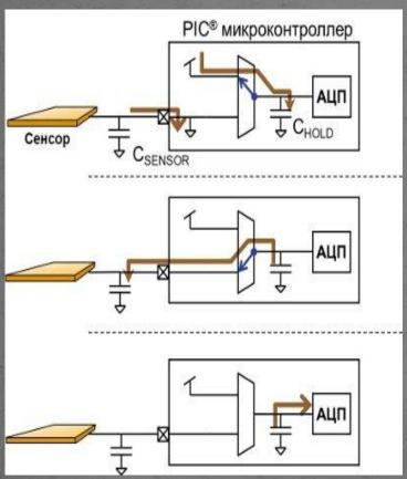
Обе емкости заряжаются до фиксированных разнополярных значений напряжений
