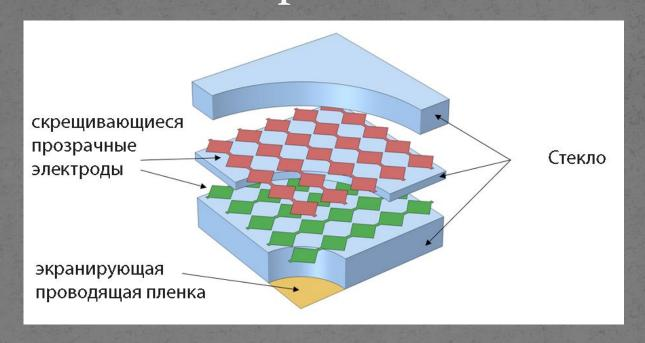
При приближения пальца к экрану емкость электродов находящихся под пальцем изменяется и таким образом, контроллер определяет место касания, т.е. координаты касания, это пересекающиеся электроды с возросшей емкостью.
