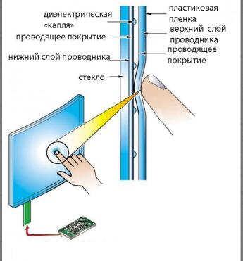
Резистивный экран представляет из себя LCD дисплей, на который наложены две прозрачные пластины, разделенные слоем диэлектрика. Верхняя пластина гибкая, так как на нее нажимает пользователь, нижняя же жестко закреплена на экране. На обращенные друг к другу поверхности нанесены проводники. Изменение сопротивления фиксируется микроконтроллером и таким образом определяются координаты точки касания
