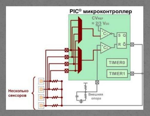
Увеличение числа емкостных кнопок за счет использования встроенного мультиплексора
