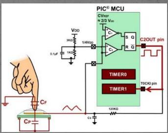
Частота опорного генератора сравнивается с частотой генератора с частотнозадающей RC цепочкой Ср+Сь.
