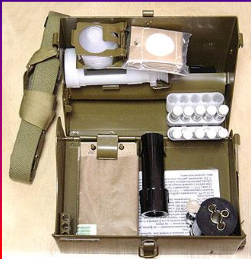
Войсковой прибор химической разведки (ВПХР)
