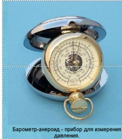
Барометр-анероид - прибор для измерения давления.
