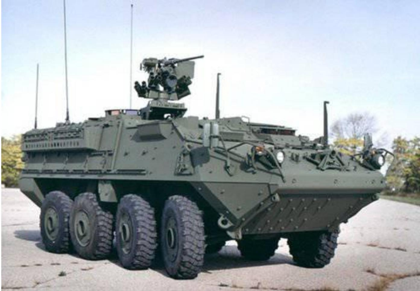
**М1126 пехотный бронетранспортер (ICV)** – основной бронетранспортер семейства боевых машин «Страйкер», предназначенный для транспортировки мотопехотного отделения на поле боя, ведения им боя с машины и огневой поддержки в период и после спешивания. М1126 «Страйкер» применяется также для ведения разведки, охраны, патрулирование, связи; иногда - для доставки на поле боя оружия, боеприпасов и других военных грузов, эвакуации раненых.
