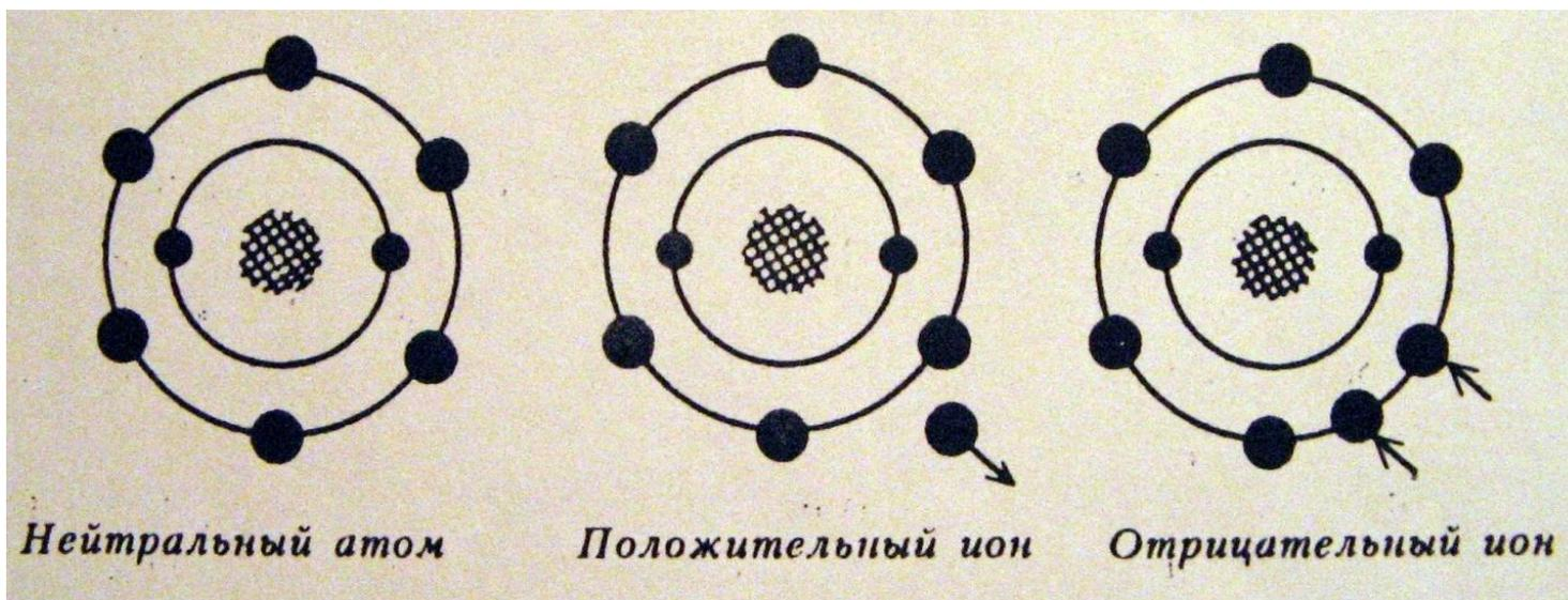
Схема образования первичных (атомарных) ионов
