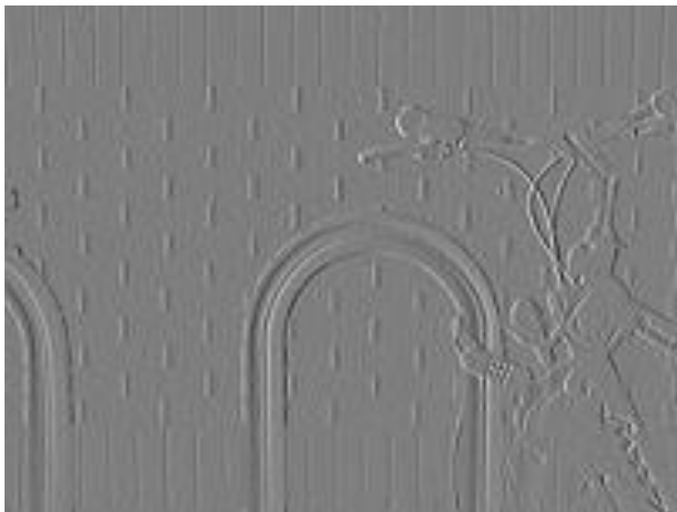
Пример использования горизонтальной составляющей оператора Собеля
