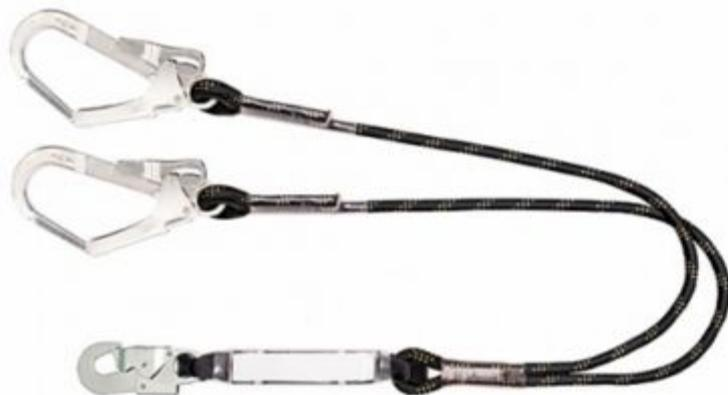
Двухплечный строп в виде плетеного полиамидного шнура с индикатором изнашивания. Оснащен разрывным ленточным амортизатором.
