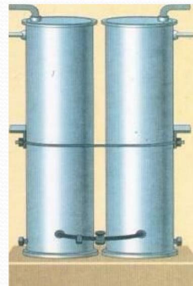
Вертикальный бак аварийного запаса воды
