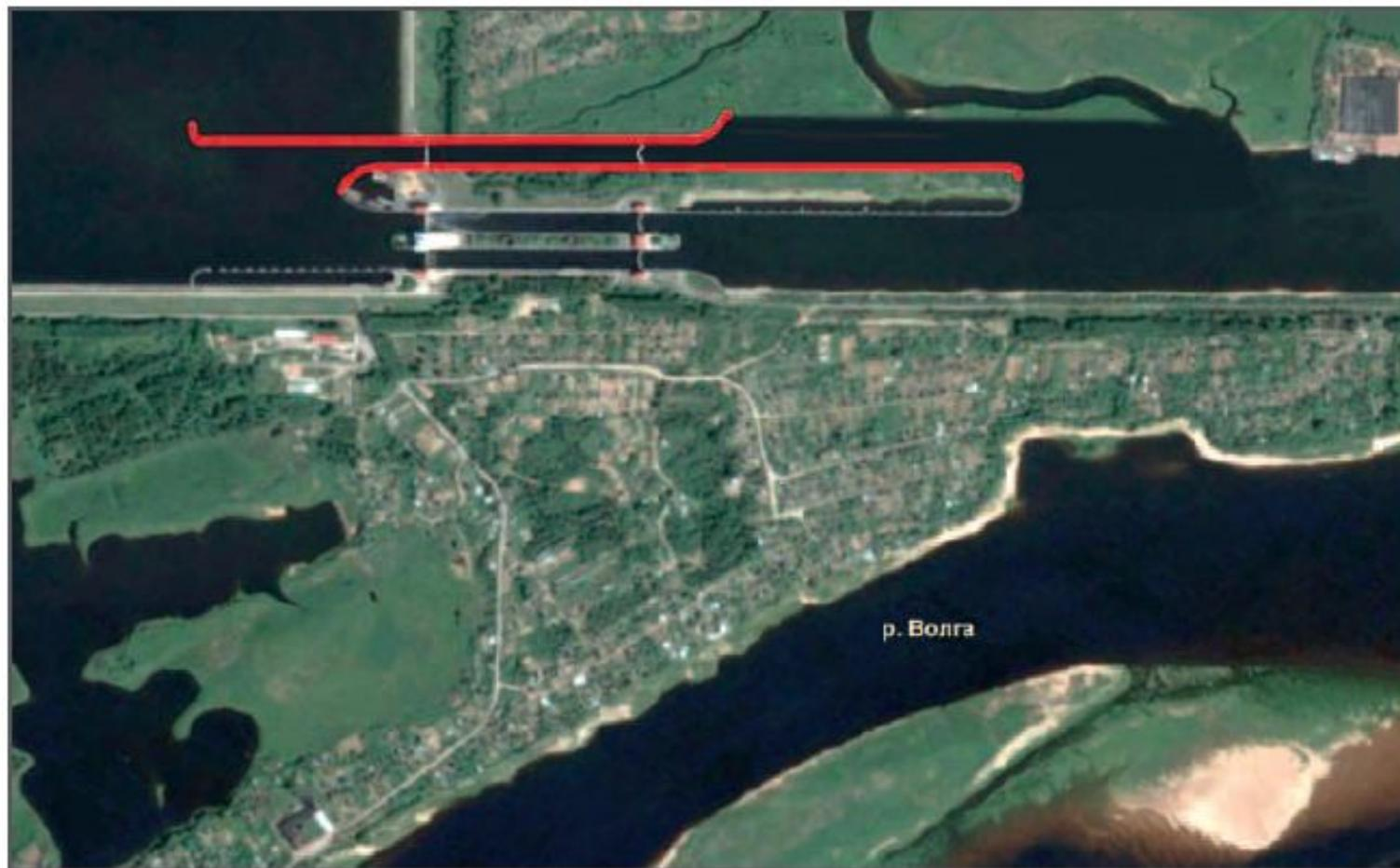
Рис. 4.5. Схема расположения третьей нитки Городецкого шлюза
