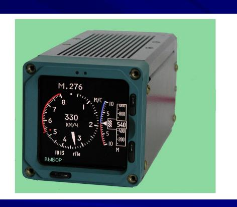
Прибор пилотажный комбинированный резервный ППКР-СВС предназначен для измерения и индикации барометрической высоты, вертикальной скорости, приборной скорости и числа М с компенсацией аэродинамических погрешностей приемников воздушных давлений как функции числа М, а также для выдачи электрических сигналов в коде во взаимодействующее оборудование.
