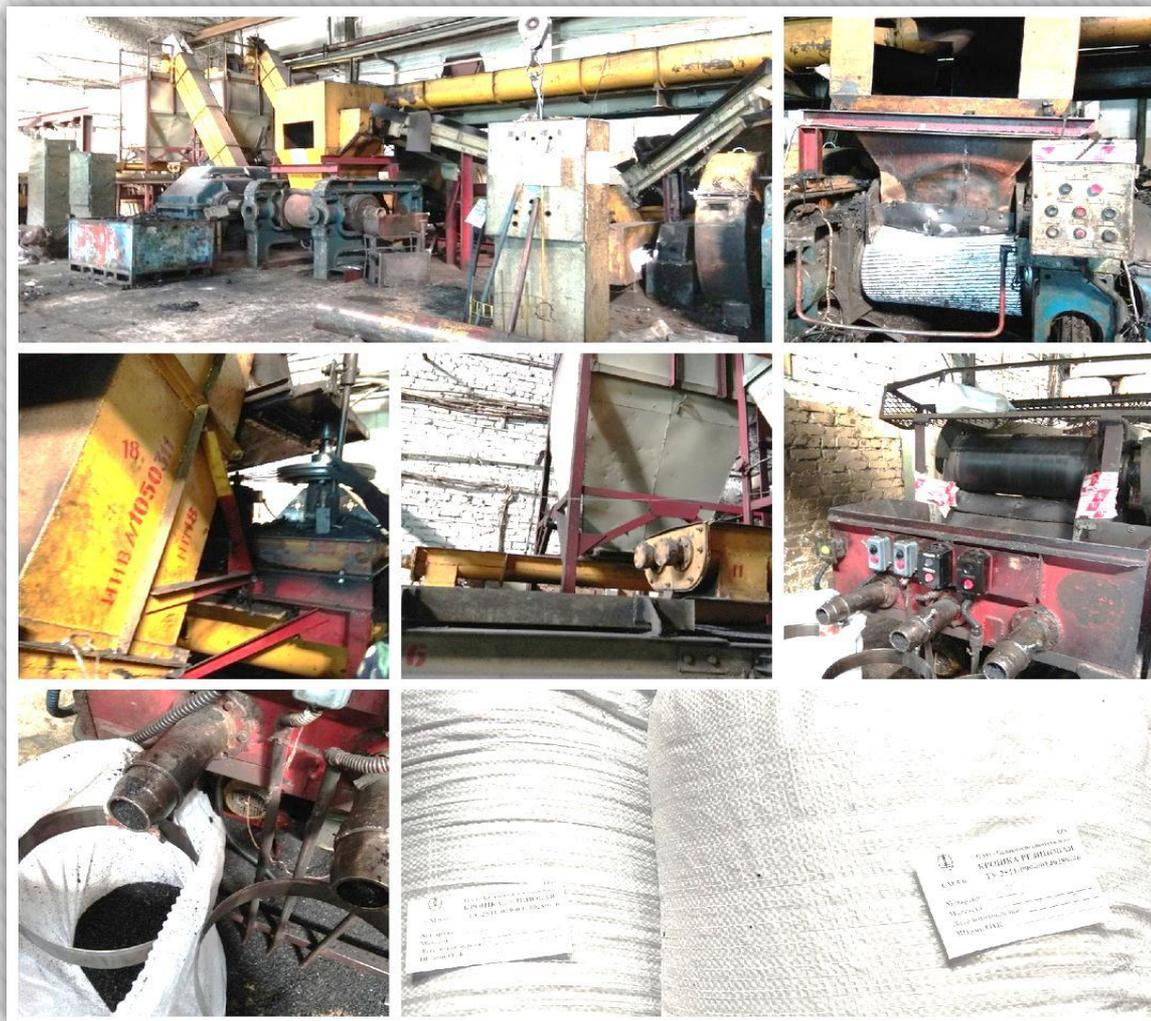
Посещала участок переработки резиновых отходов, наблюдала за технологией переработки вулканизированной резины и получением отходов резиновой крошки диаметром 0,63; 1; 5 мм.
