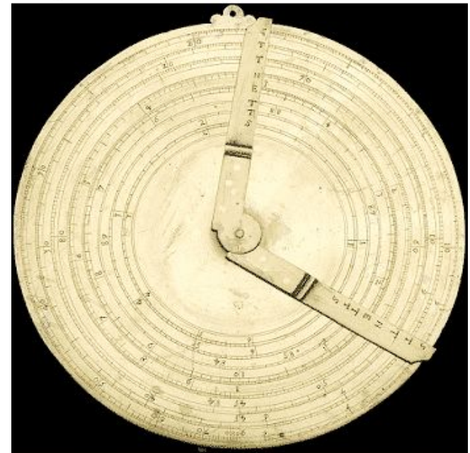
Модель круговой логарифмической линейки, выполненная по описанию Уильяма Отреда
