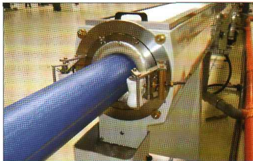
Фото 2. При выходе трубы из второй вакуумной камеры щеточный уплотнитель гарантирует изоляцию от внешней среды
