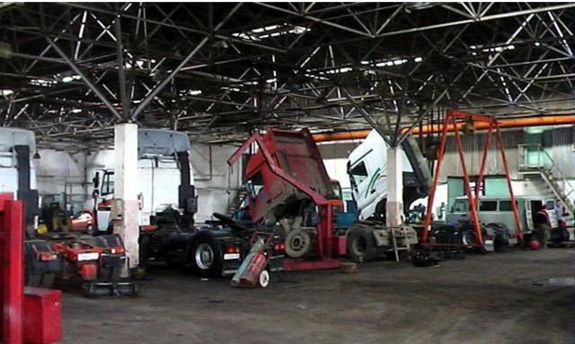
Для подъема и транспортирования агрегатов и других грузов применяют передвижные краны, грузовые тележки, подъемные ручные тали или электротельферы, **кран-балки**
