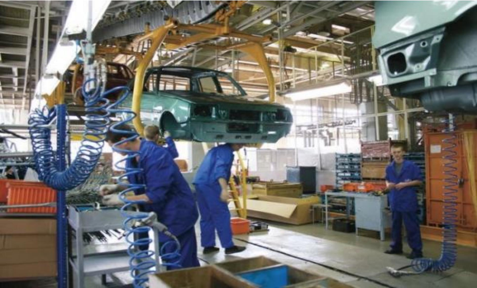
По способу передачи движения автомобилю конвейеры подразделяются на толкающие, несущие и тянущие
