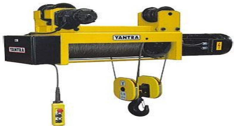
Для подъема и транспортирования агрегатов и других грузов применяют передвижные краны, грузовые тележки, подъемные ручные тали или электротельферы, кран-балки
