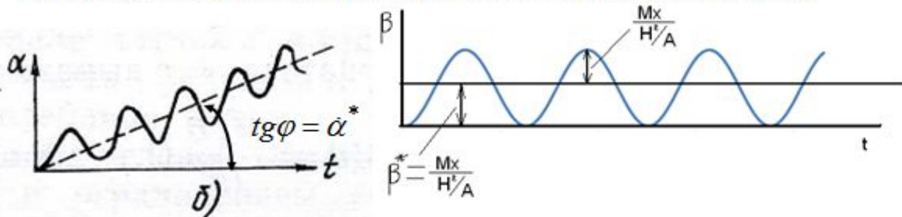
**При действии постоянного момента относительно оси внутренней рамки гироскоп прецессирует с постоянной угловой скоростью**
