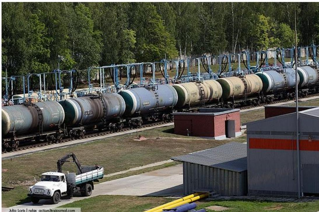
Установка цистерн под слив руководит ответственное лицо имеющее соответствующее удостоверение. Цистерны фиксируются тормозными башмаками из не искрящего материала и заземляется.
