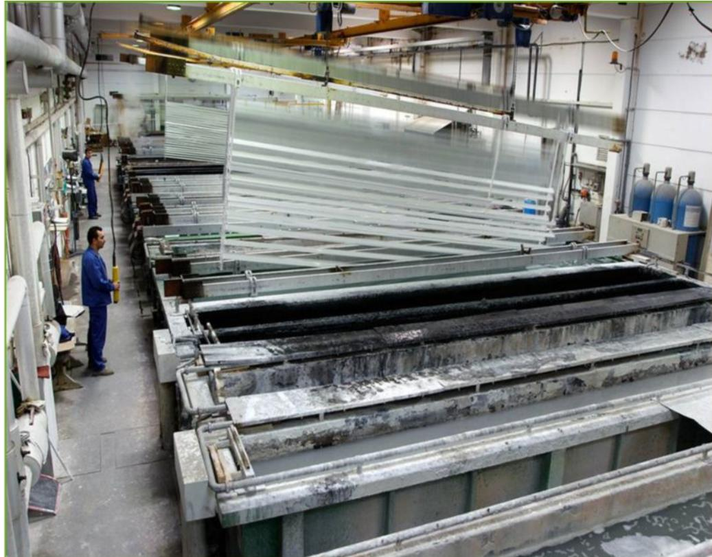
Окисление профиля или выгорание свободного углерода, путем воздействия на профиль агрессивного кислотного раствора.
