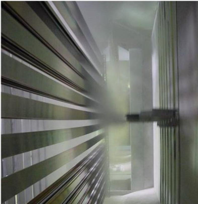
Посредством сжатого воздуха подаваемый порошок электростатически притягивается к профилю и распределяется по нему, что обеспечивает целостность процесса покраски
