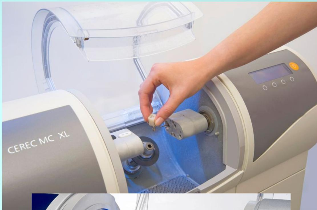
Эти станки могут обрабатывать различные материалы (цирконий, титан, композиты, пластмассу для временных конструкций)
