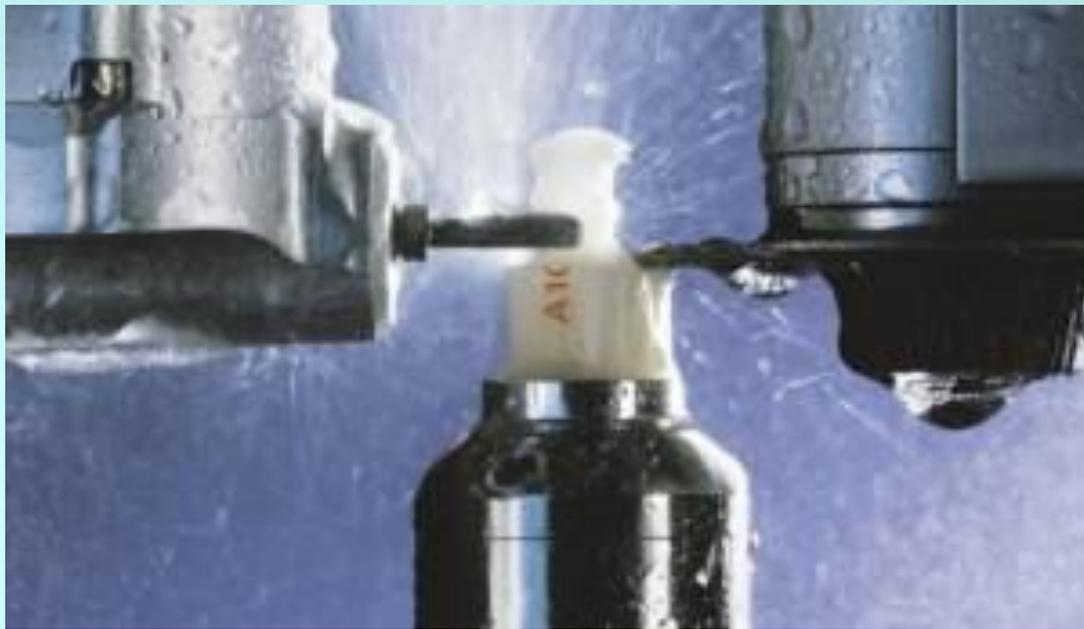
Созданные в САD-программе цифровые файлы зубов передаются в САМ систему (**Компьютерное Автоматическое Производство**), которая состоит из программы и фрезерного станка с ЧПУ. Программа генерирует траектории обработки во фрезерном станке до микрон.
