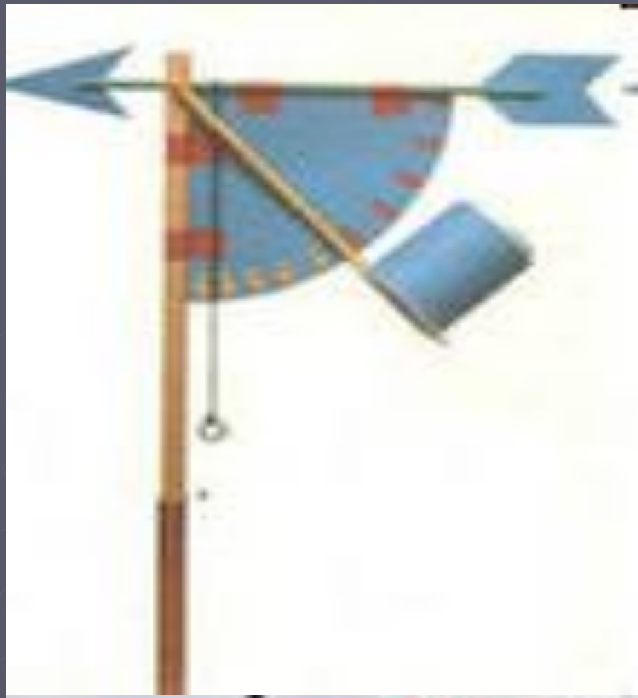
Анемометр-прибор для измерения скорости ветра
