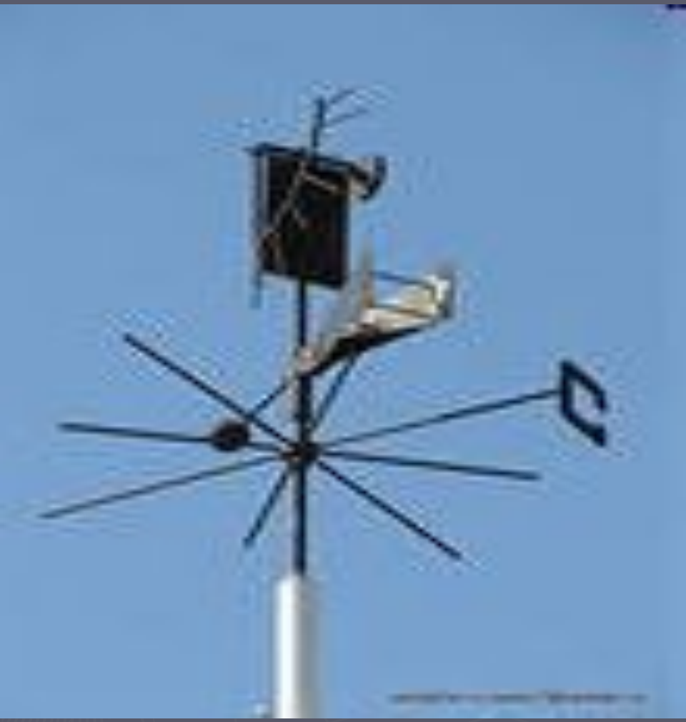
Анемометр-прибор для измерения скорости ветра
