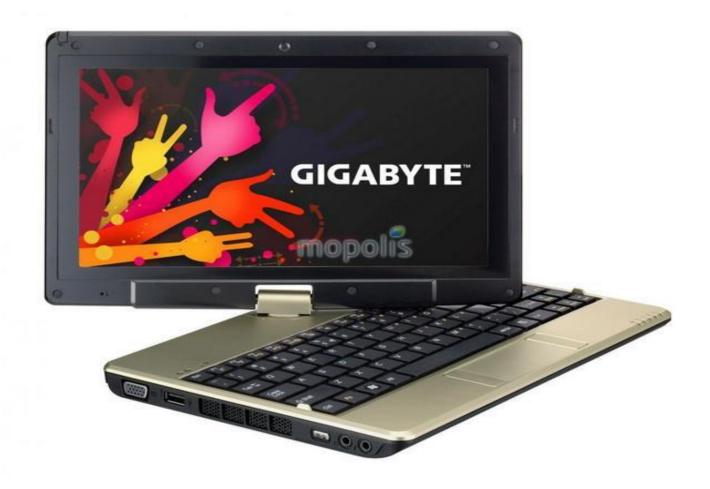
Аппарат является трансформером – его экран может разворачиваться на шарнире, и за счет этого он может работать в двух режимах.
