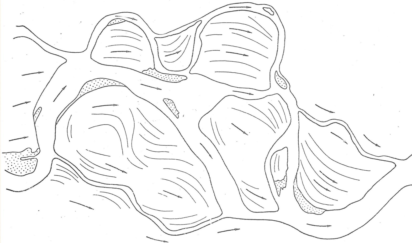
Рис. 68. Пойменный массив при незавершенном меандрировании. Течения на пойме согласуются с рельефом ее поверхности и направлением проток во все фазы развития транзитного потока.
