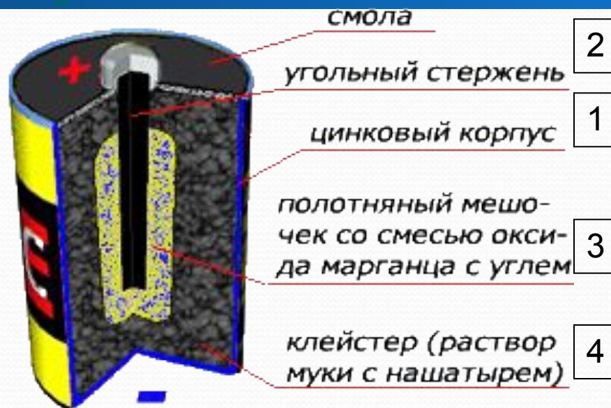
Цинково-марганцевый элемент
