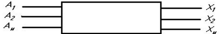
На каждый вход подаются сигналы только двух видов, обозначаемые 0 и 1. Такие же сигналы появляются на каждом выходе.
