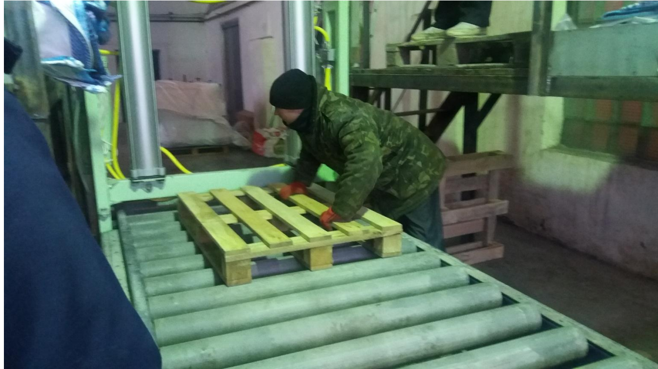
Підставити дерев'яний піддон під місце завантаження біг-бегу
