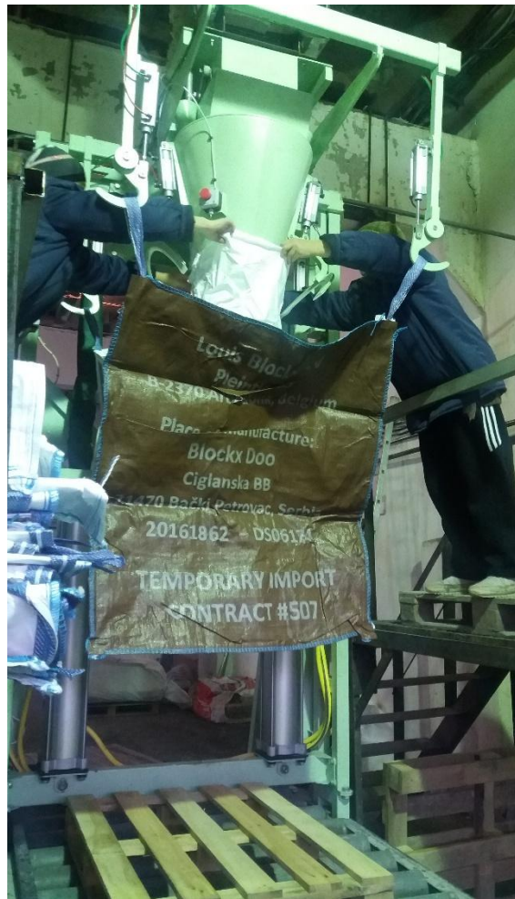
Горловину мішка надіти на горловину дозатору
