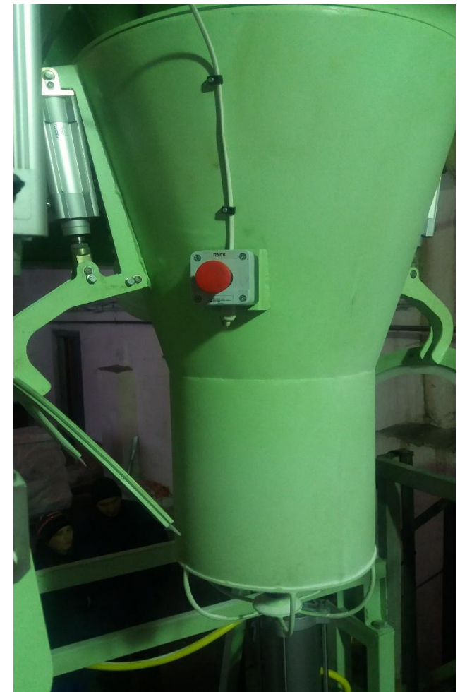
Для засипки цукру в біг-бег натиснути червону кнопку «Пуск»
