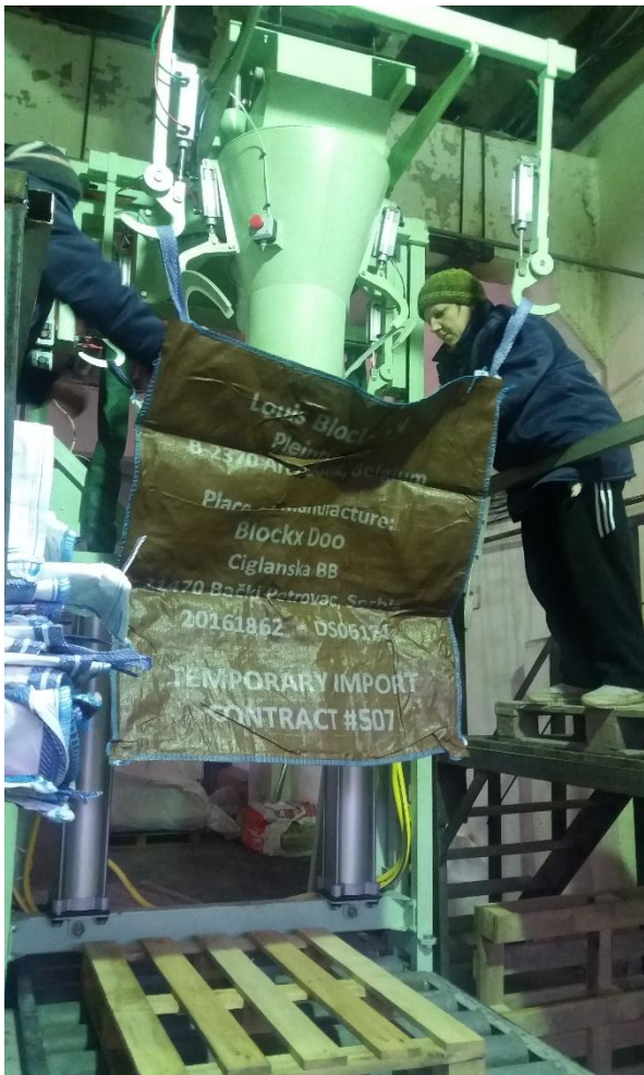
Повісити біг-бег за ручки на гаки дозатору
