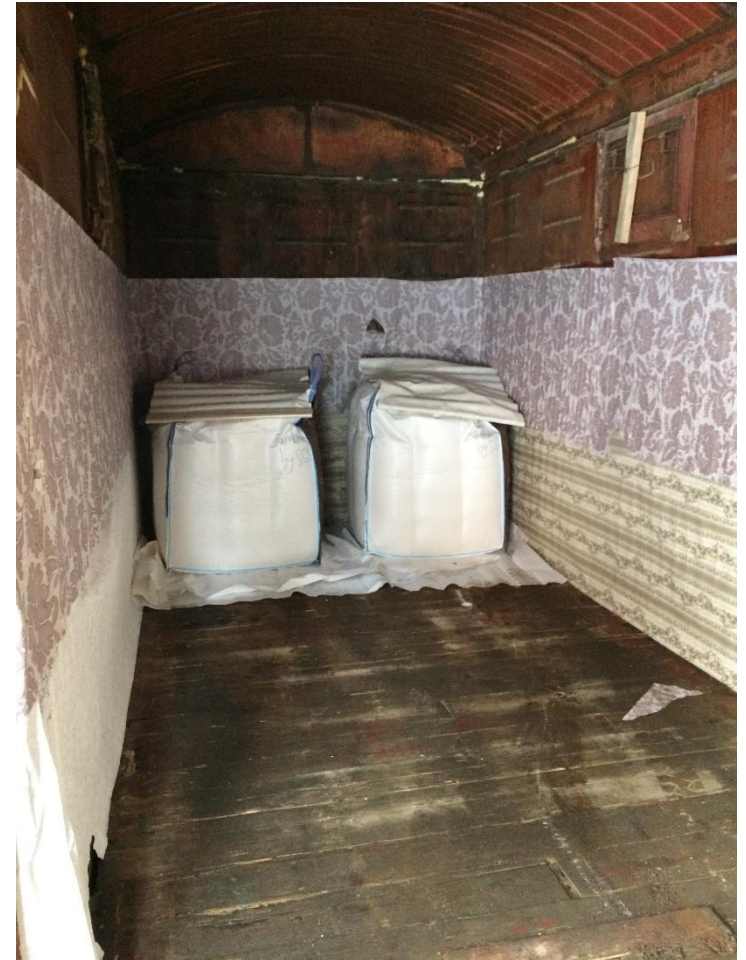
Кожний нижній шар біг-бегів зверху накрити шпалерами перед укладанням другого шару
