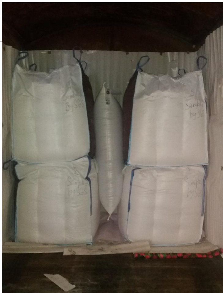
Після укладки 4-х біг-бегів між ними надувається повітряна подушка
