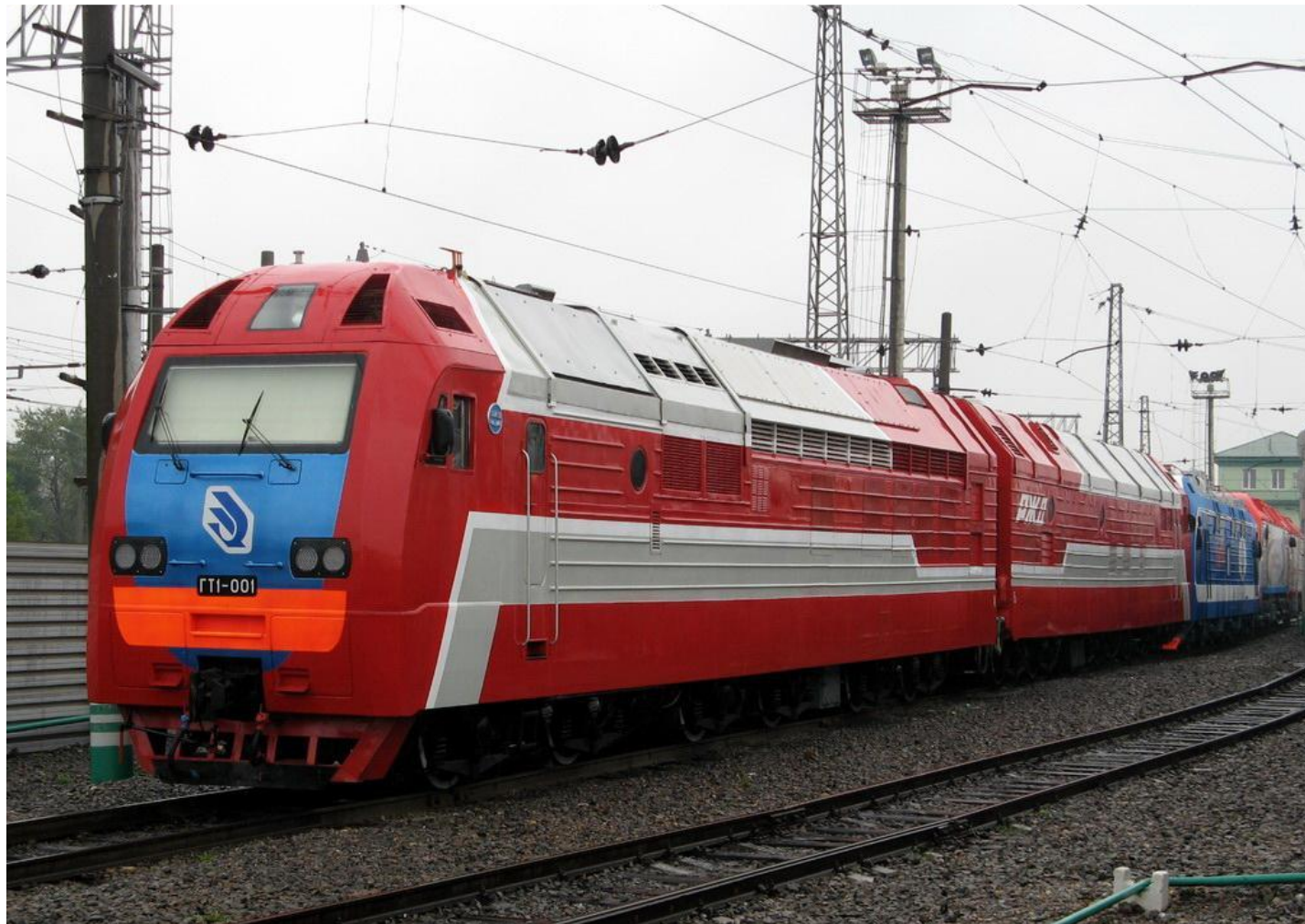
Газотурбовоз ГТ-1. Год выпуска 2007. Мощность 8300 кВт
