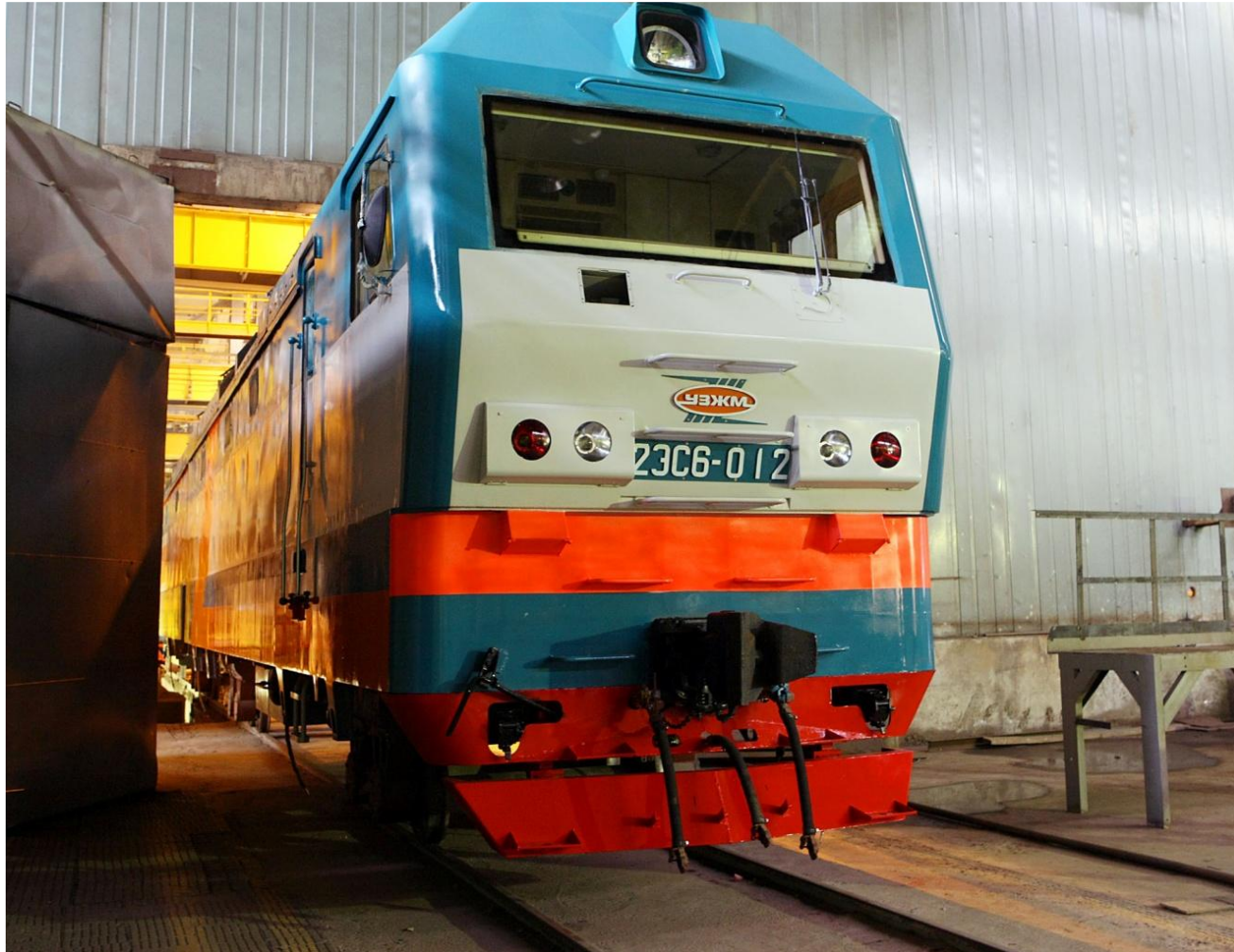
Грузовой магистральный электровоз 2ЭС6. Год выпуска - 2007. Мощность 6440 кВт
