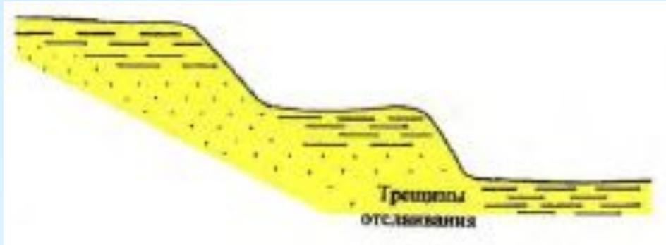
Трещины отслаивания, параллельные поверхности речных террас
