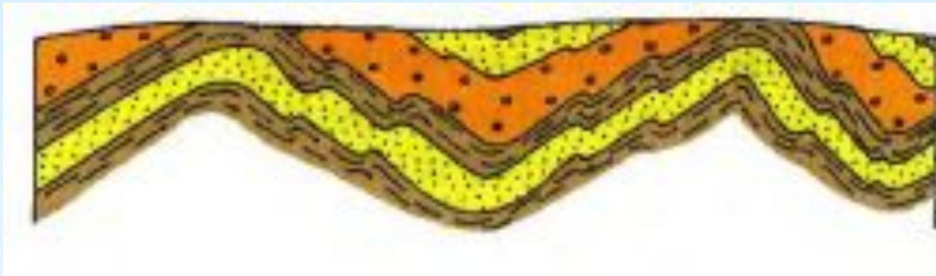
Крылья крупной складки, осложненные более мелкой складчатостью
