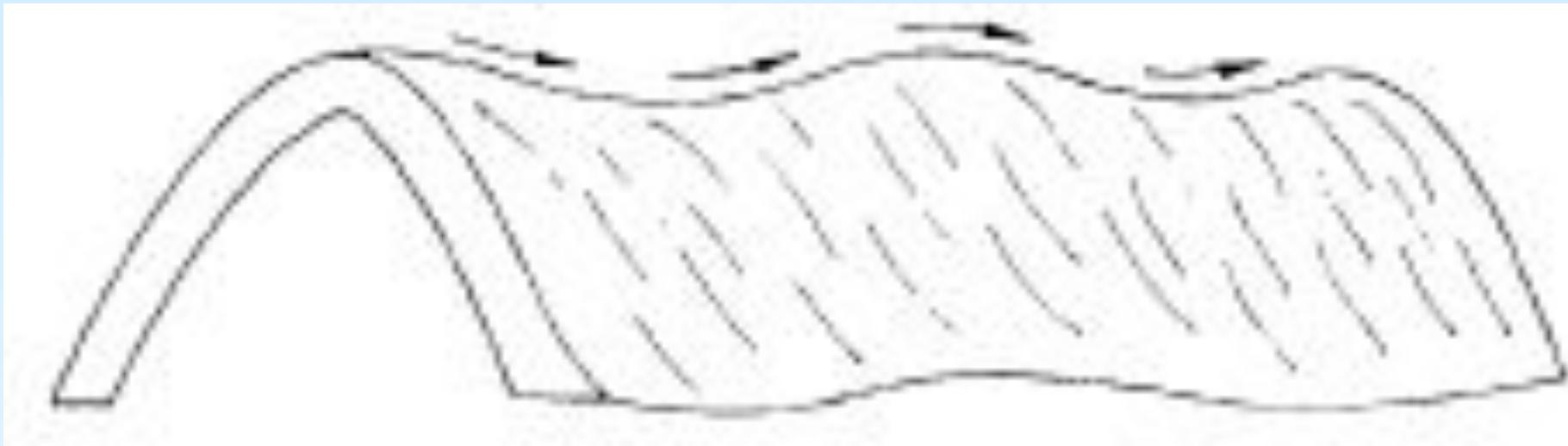
Волнистый шарнир (ундуляция шарнира: его воздымание и погружение)
