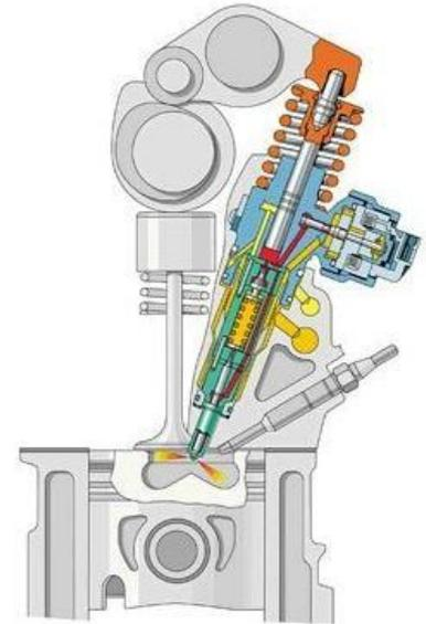
Форсунка (другое название - *инжектор*), являясь конструктивным элементом системы впрыска, предназначена для дозированной подачи топлива, его распыления в камере сгорания (впускном коллекторе) и образования топливно-воздушной смеси.
