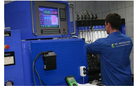
Процесс диагностики начинается прямо в автомобиле. Таким образом, можно сразу определить причину неисправности и тут же устранить ее. В случае же, если при первичном диагностировании не удастся обнаружить факторы, которые привели к поломке, производится снятие топливного насоса и дальнейшая проверка его на стенде.
