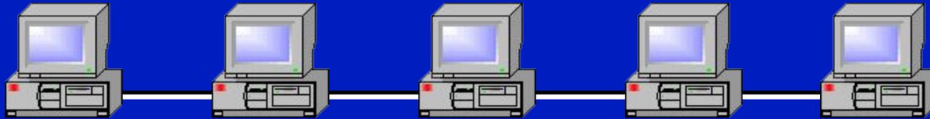
**Общая шина** — все компьютеры параллельно подключаются к одной линии связи. Информация от каждого компьютера одновременно передается всем остальным компьютерам.
