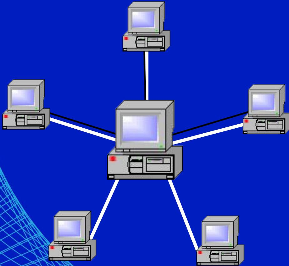
**Звезда** — все компьютеры, используя отдельную линию связи, соединяются с центральным узлом - сервером
