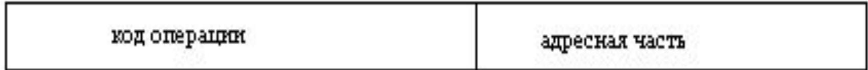
Команда – это цифровой двоичный код, состоящий из двух подпоследовательностей двоичных цифр, одна из которых определяет код операции (сложить, умножить, переслать), вторая – определяет операнды, участвующие в операции и место хранения результата.
