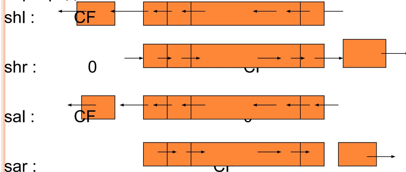
Здесь знаковый бит распространяется на сдвигаемые разряды. Например, (AL) = 1101 0101
