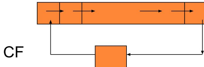
Для всех команд сдвига флаги ZF, SF, PF устанавливаются в соответствии с результатом. AF – не определен. OF – не определен при сдвигах на несколько разрядов, при сдвиге на 1 разряд в зависимости от команды:
