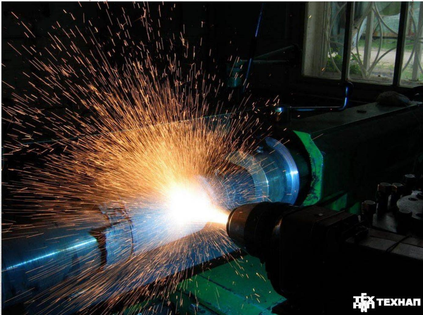
Электродуговая металлизация - это нагрев (до плавления) электрической дугой в распылителе сходящихся проволок. Капли расплавленного металла сдуваются затем газовым потоком в направлении подложки, где и создается металлопокрытие.
