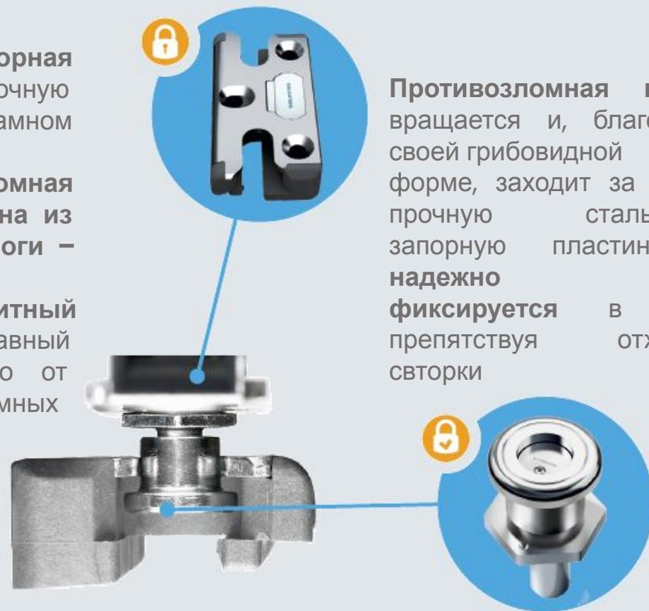
Противовзломная цапфа вращается и, благодаря своей грибовидной форме, заходит за особо прочную стальную запорную пластину и **надежно фиксируется** в ней, препятствуя отжиму створки
