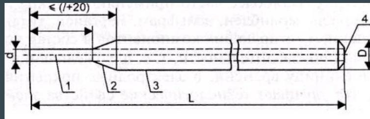
Один из концов стержня освобожден от покрытия для его зажатия в электродо-держателе с обеспечением электрического контакта. Второй конец только слегка очищен для облегчения зажигания дуги посредством контакта с изделием. На контактный торец электрода может быть нанесен слой ионизирующего вещества, облегчающего возбуждение сварочной дуги, состав которого должен соответствовать предусмотренному стандартом или техническими условиями на электроды конкретной марки.
