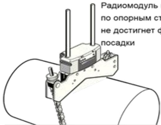
Радиомодуль надвигается по опорным стержням, пока не достигнет фрикционной посадки
