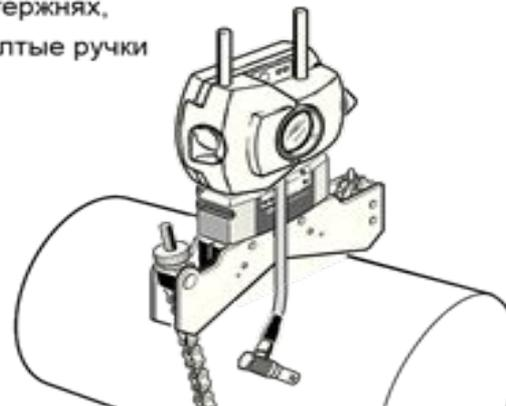
Закрепить датчик на опорных стержнях, затянув желтые ручки
