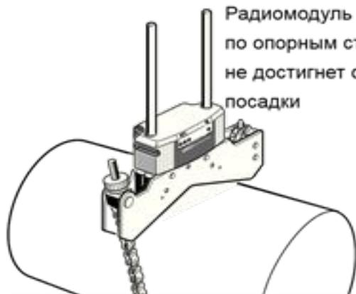
Радиомодуль надвигается по опорным стержням, пока не достигнет фрикционной посадки
