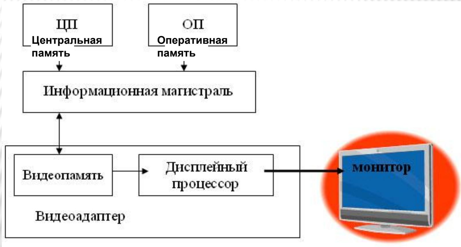
Практически все современные видеокарты принадлежат к комбинированным устройствам и помимо своей главной функции - формирования сигналов, в соответствии с которыми монитор может отображать ту или иную информацию на экран, - осуществляют ускорение выполнения графических операций. Такие устройства называются **видеоадаптерами** (*видеоконтроллерами*).
