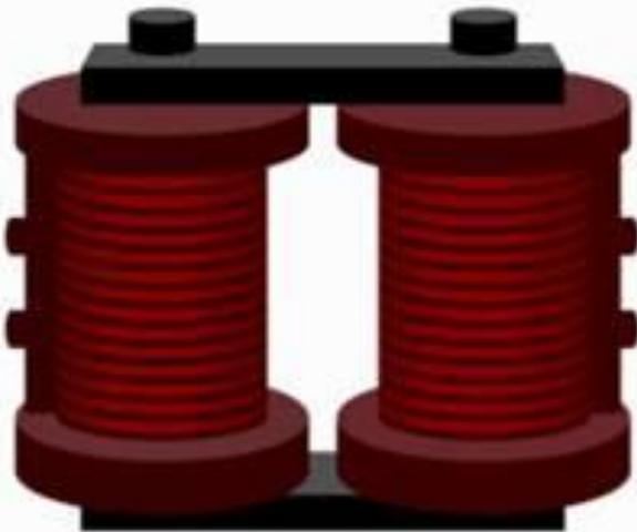
Трансформатор состоит из двух катушек или большого количества катушек, надетых на общий сердечник.
