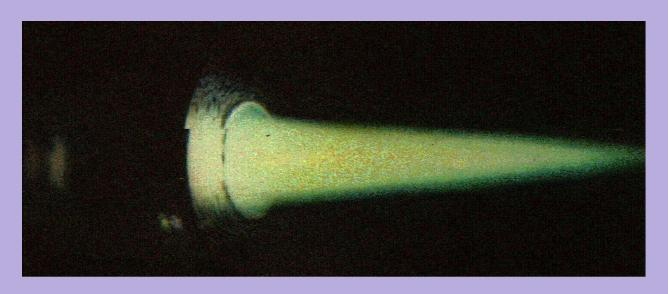
Существуют генераторы низкотемпературной плазмы — плазмотроны, в которых используется электрическая дуга. С помощью плазмотрона можно нагреть почти любой газ до 7000—10000 градусов за сотые и тысячные доли секунды. С созданием плазмотрона возникла новая область науки — плазменная химия: многие химические реакции ускоряются или идут только в плазменной струе.
