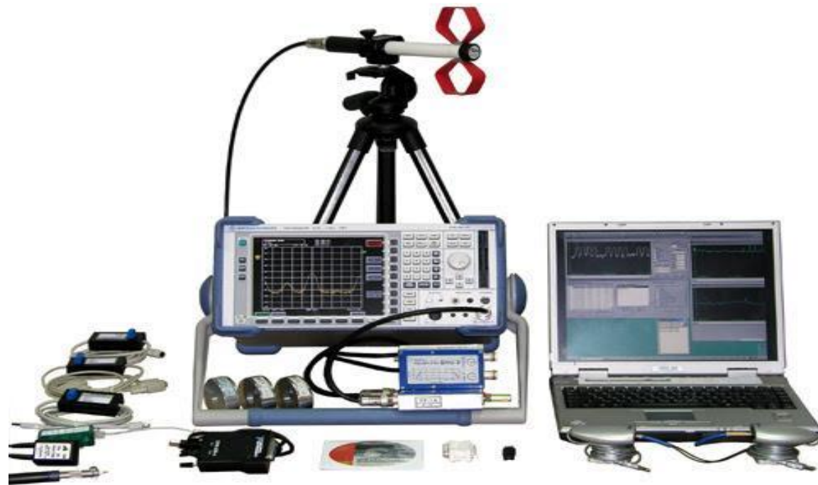
Система оценки защищенности по каналу ПЭМИН «СИГУРД»
