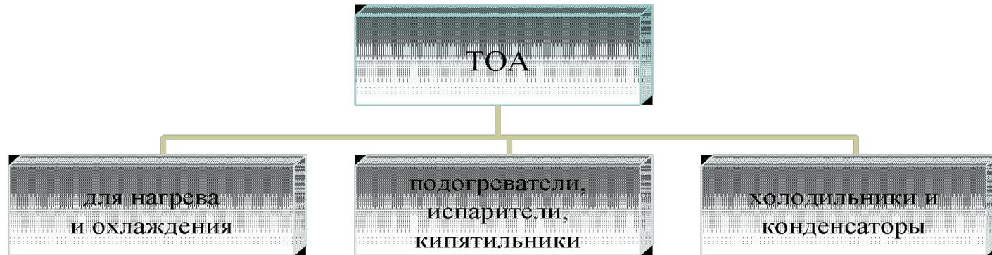
**Теплообменники** – аппараты для *регенерации* тепла, уносимого отходящими потоками. *Целевым процессом*, протекающим в них, может являться *нагрев* холодного потока, или *охлаждение* горячего, или тот и другой процесс в равной степени.
