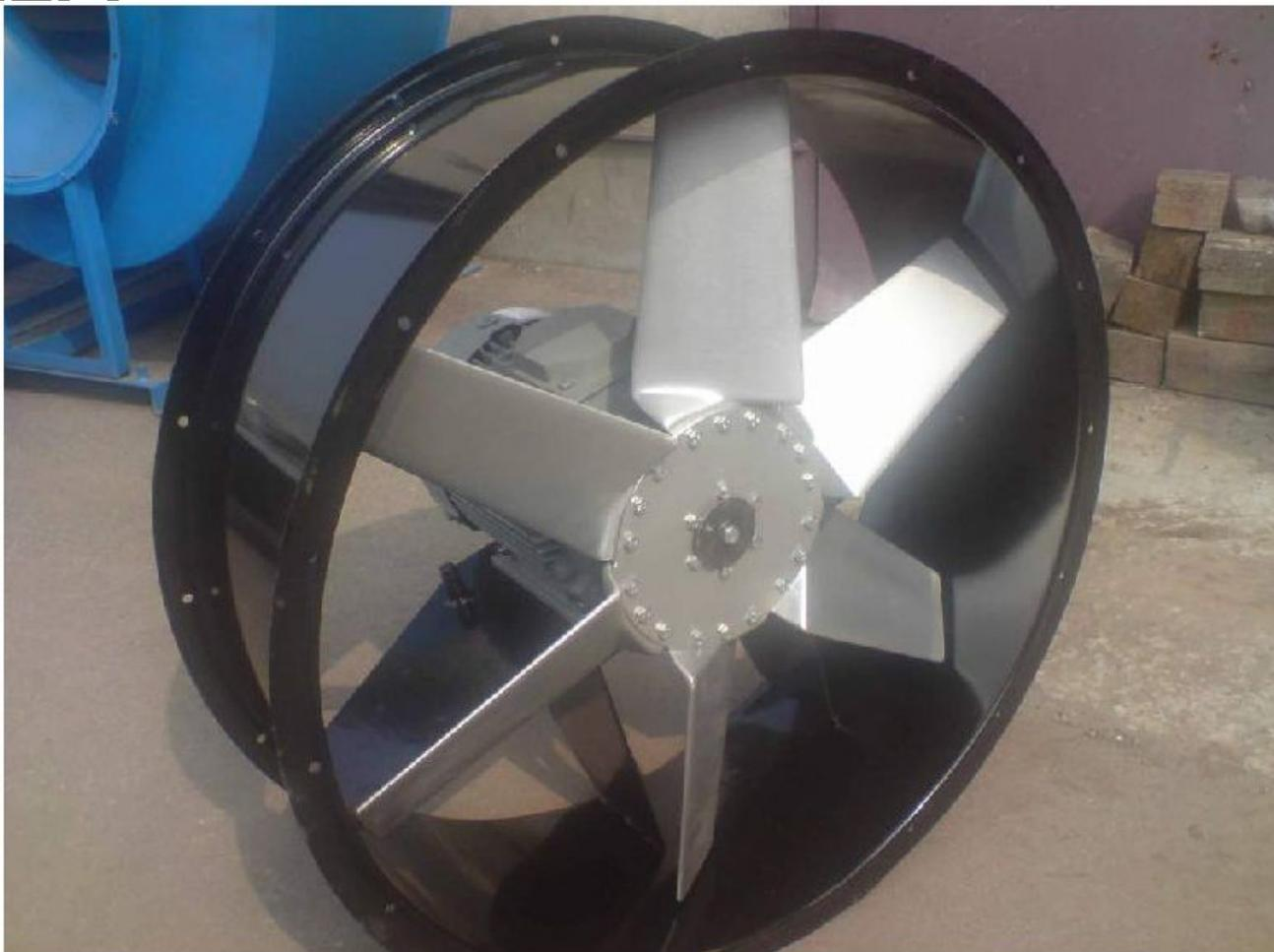
*Общий вид колеса вентилятора АВО с приводом*
