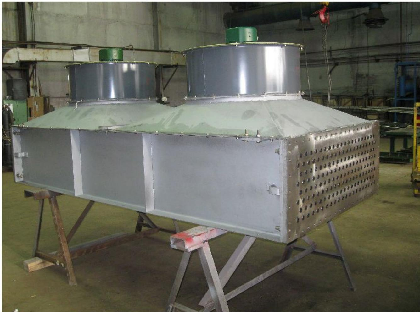
Одноходовая секция АВО со снятой крышкой распределительной камеры
