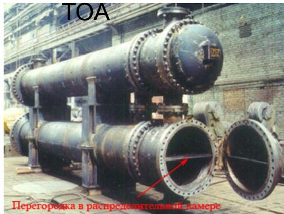
Перегорodka в распределительной камере
