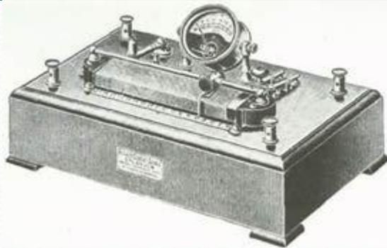
"импульсный генератор Ледюка"
