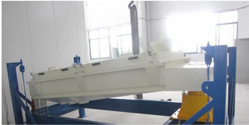
Полувибрационный (или гирационный) грохот характеризуется круговым движением сита в вертикальной плоскости, вызываемым эксцентриковым приводным механизмом (эксцентриковым валом)
